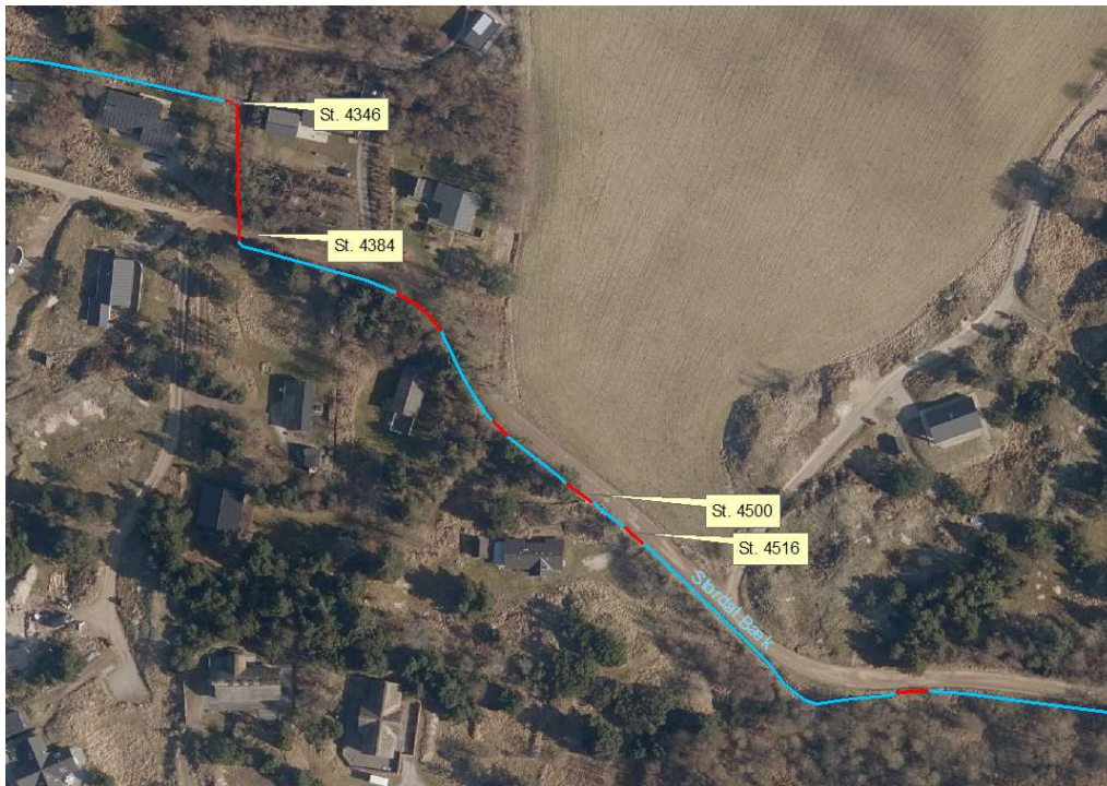
Figur 1: Stordal Bæk krydses i st. 4346 og 4384 m med hovedledning og i st. 4500 og 4516 m med stikledninger. Stordal Bæk er vist med en blå streg, hvor røde markeringer er rørlægninger i vandløbet.
